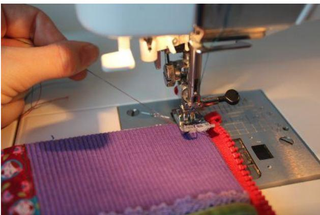
Steppe nun, beginnend auf der Seite der Wendeöffnung, die Jacke ringsherum ab. Dabei wird auch die Wendeöffnung verschlossen. Am Nahtbeginn kann es vorkommen, dass der Stoff durch die Dicke schlecht transportiert wird. Sollte dies der Fall sein, dann ziehe einfach etwas an den beiden Fadenenden des Ober- und Unterfadens.
