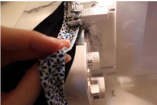
Beim Annähen achte darauf, die Streifen leicht zu dehnen. In der Mitte der Rundung des Vorderteils muss der Streifen etwas mehr gedehnt werden, damit er nachher schön anliegt.
